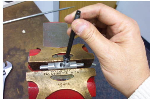
39. Remove plunger tube (Item 10). (Reassembly recommendations; replace o-ring (item 9). Use Loctite 242 or equivalent on plunger tube threads.) 39. Entfernen Sie Spulenkernschlauch (Einzelteil 10). (Ressembly Empfehlungen; ersetzen Sie O-Ring (Einzelteil 9). verwenden Sie Loctite 242 oder Äquivalent auf Spulenkernschlauchgewinden.)
