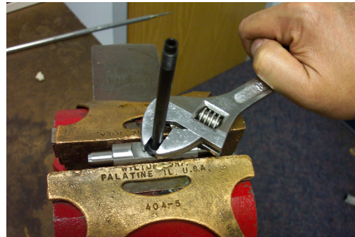
38. Loosen plunger tube (Item 10) from outlet pin (Item 8). (reassembly torque: 100-110 in.-lbs. (11.2 - 12.4 Nm).) 38. Lösen Sie Spulenkernschlauch (Einzelteil 10) vom Anschlußstift (Einzelteil 8). (Wiederversammlungsdrehkraft: 11,2 - 12,4 Nm (100-110 in.-lbs.).)
