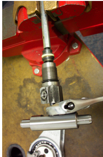
31. Loosen plunger tube (Item 10). (Reassembly torque: 100-110 in. lbs. (11.3 - 12.4 Nm)). 31. Lösen Sie Spulenkernschlauch (Einzelteil 10). (Wiederversammlungsdrehkraft: 11,3 - 12,4 Nm (100-110 inch lbs.).)
