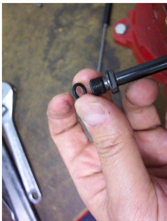
40. Remove O-ring (Item 9). 40. Entfernen Sie O-Ring (Einzelteil 9).
