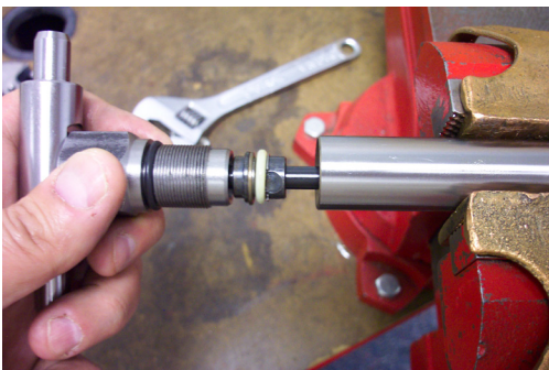
30. View of plunger tube and plunger tube bushing assembly (Items 10, 10a, 10b, 10c and 10d). 30. Ansicht des Spulenkernschlauches und der Spulenkernschlauchbuchse (Einzelteile 10, 10a, 10b, 10c und 10d).
