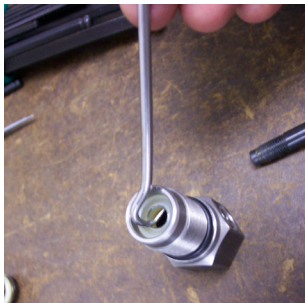
35. Pull cup seal (Item 15) out of wrist pin anchor (Item 13a). 35. Ziehen Sie Schale Dichtung (Einzelteil 15) Handgelenkstift Anker heraus (Einzelteil 13a).
