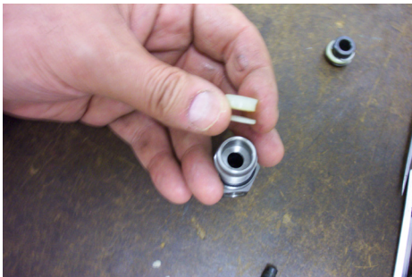
36. Remove cup seal (Item 15) and backup washer (Item 14). (Reassembly recommendations: replace cup and seal and backup washer. See detail below for orientation.) 36. Enlevez le joint de tasse (article 15) et la rondelle de secours (article 14). (recommandations de remontage : remplacez la rondelle de tasse et de joint et de protection.)
