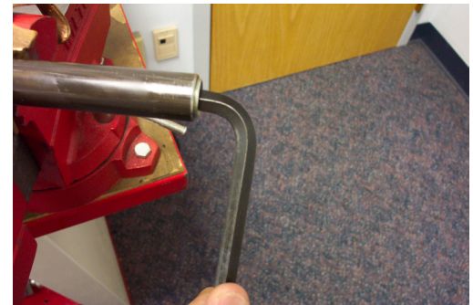
46. Loosen check seal housing (Item 27) with 3/8 Allen wrench. (Reassembly torque: 20-25 ft. lbs. (27.1 - 33.9 Nm).) 46. Lösen Sie Überprüfung Dichtungsgehäuse (Einzelteil 27) mit 3/8 Inbusschlüssel. (Wiederversammlungsdrehkraft: 27.1 - 33.9 Nm (20-25 ft. lbs.).)
