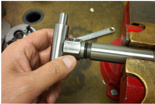
29. Remove wrist pin anchor (Item 13a). (Reassembly recommendations: replace O-ring seal (Item 13b), be sure threads on wrist pin anchor (Item 13a) are clean and free of all oil or other fluids.) 29. Entfernen Sie Handgelenkstift Anker (Einzelteil 13a). (Reassembly Empfehlungen: ersetzen Sie O-Ring Dichtung (Einzelteil 13b), seien Sie sicher, daß Gewinde auf Handgelenkstift Anker (Einzelteil 13a) sauber und von allem Öl oder von anderen Flüssigkeiten frei sind)
