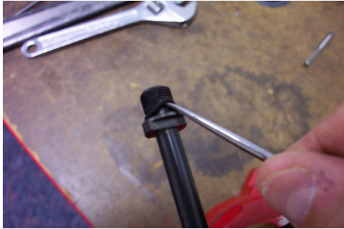
40. Remove O-ring (Item 9). 40. Entfernen Sie O-Ring (Einzelteil 9).
