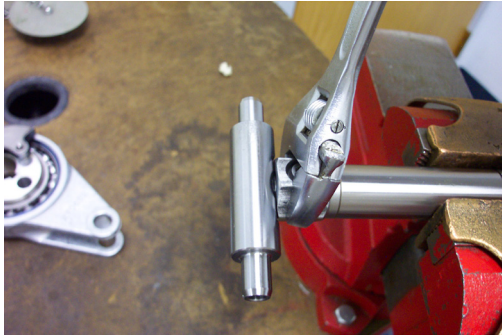
28. Loosen wrist pin anchor (Item 13a). (Reassembly torque: 20 - 25 Ft. Lbs. (27.1 - 33.9 Nm).) 28 Lösen Sie Handgelenkstift Anker (Einzelteil 13a). (Wiederversammlungsdrehkraft: 27,1 - 33,9 Nm (20 - 25 Ft. Lbs.).)
