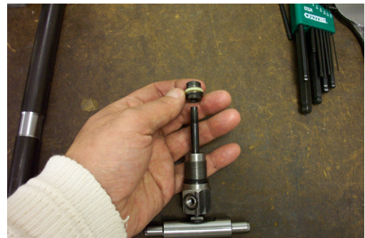
33. View of bushing assembly (Items 10 through 10d) removed. 33. Ansicht der Buchse (Einzelteile 10 durchgehende 10d) entfernt.
